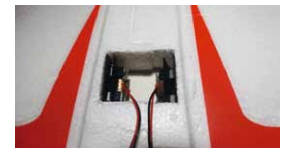
Nach dem Zusammenstecken der Flächenhälften wird ausgemessen, in welchem Abstand die männlichen Gegenstücke montiert werden müssen
