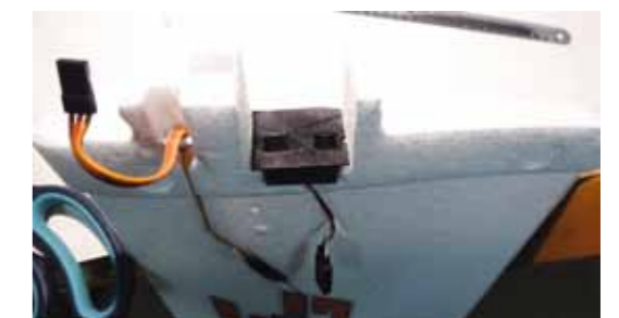
Zunächst wird die „weibliche“ Seite des Verbinders an der Tragfläche angepasst
